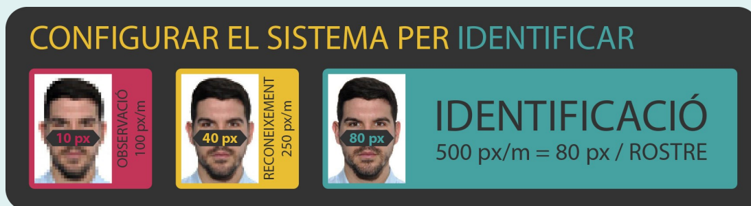
Figura 3. Imatges del rostre d'una persona mostrades a diferents resolucions. Per identificar una persona és necessària una resolució mínima de 500 px/m.
